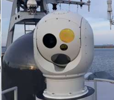
Proses Pemasangan EOTS selesai
