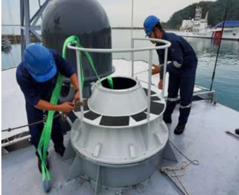
Proses Pemasangan EOTS
